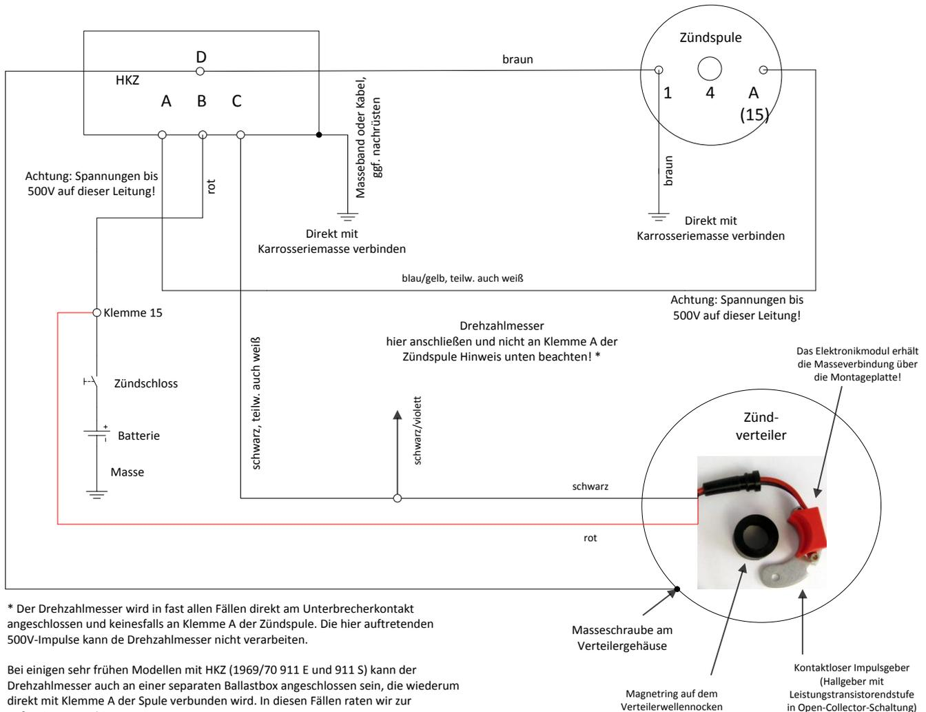
\* Der Drehzahlmesser wird in fast allen Fällen direkt am Unterbrecherkontakt angeschlossen und keinesfalls an Klemme A der Zündspule. Die hier auftretenden 500V-Impulse kann der Drehzahlmesser nicht verarbeiten.
