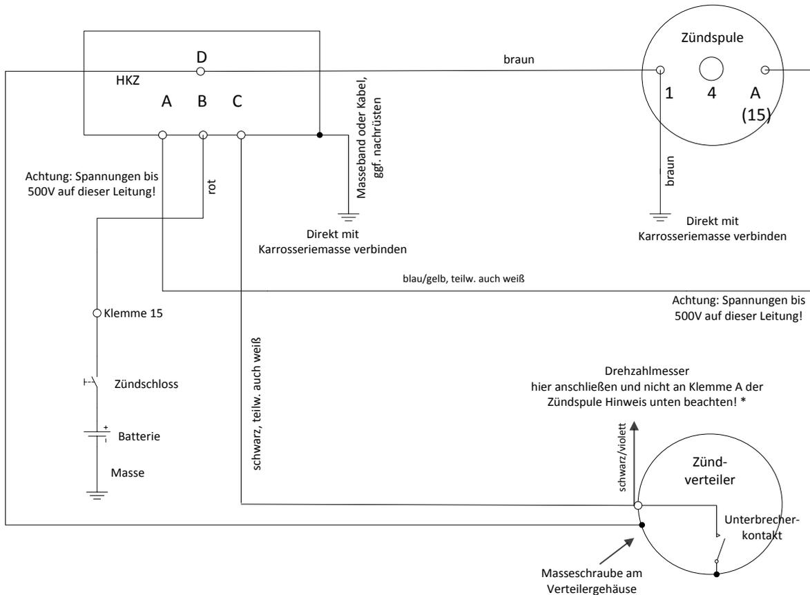
\* Der Drehzahlmesser wird in fast allen Fällen direkt am Unterbrecherkontakt angeschlossen und keinesfalls an Klemme A der Zündspule. Die hier auftretenden 500V-Impulse kann der Drehzahlmesser nicht verarbeiten.
